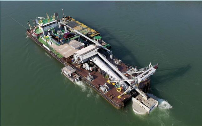
*Sohlbehebung am Oberrhein mithilfe des Taucherglockenschiffes „Carl Straat“ (Foto: Bundesanstalt für Wasserbau)*
