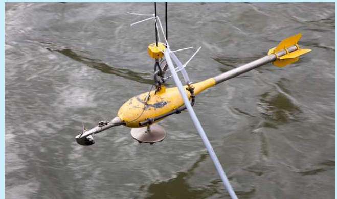
Entnahmevorrichtung für Schwebstoffproben (Foto: Bundesanstalt für Gewässerkunde)
